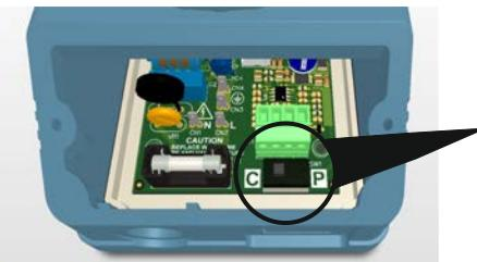
В части, относящейся к электрическим соединениям цепи, находится переключатель (показанный на рисунке), регулирующий режим дозирования насоса.
